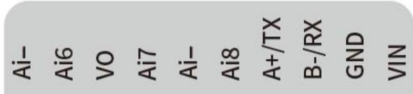
VIN 为供电电源正极, GND 为供电电源负极。
