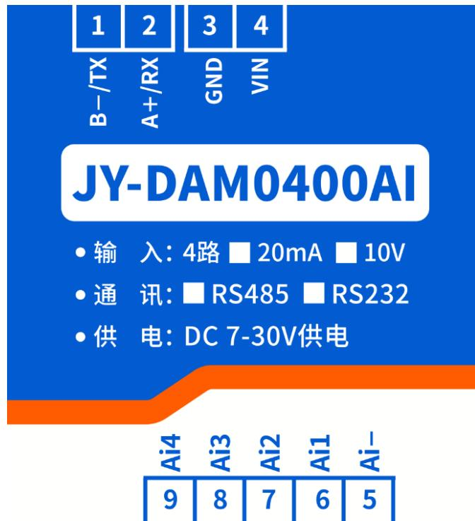
VIN 为供电电源正极, GND 为供电电源负极。
