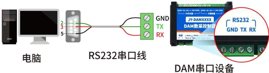
232 通讯使用 2 脚（TX）、3 脚（RX）、5 脚（GND）。其中 5 脚地线与设备上的电源负极共用。当设备通讯不上时，可检测串口线是否为直连线，将 RX 和 TX 进行交换测试。
