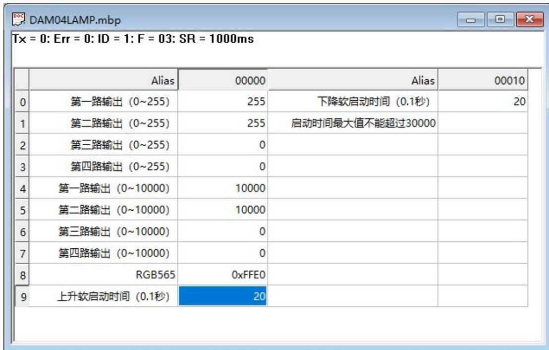
调试使用时我们可以建立 MODBUS POLL 工程，如上图所示，使用 03 指令，0 寄存器开始顺延 10 位，通讯成功后就可以进行调试和使用，如需要配置地址波特率等参数可以参照下表进行配置。
